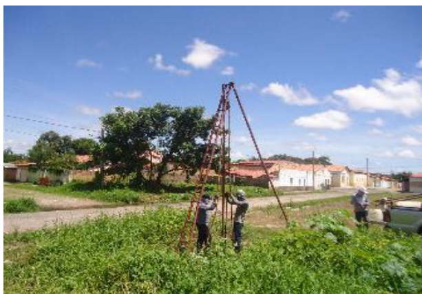
FOTO Nº 19 - REALIZAÇÃO DO TESTE DE SONDAGEM NA ÁREA DO CANAL ABERTO (BACIA 02)
